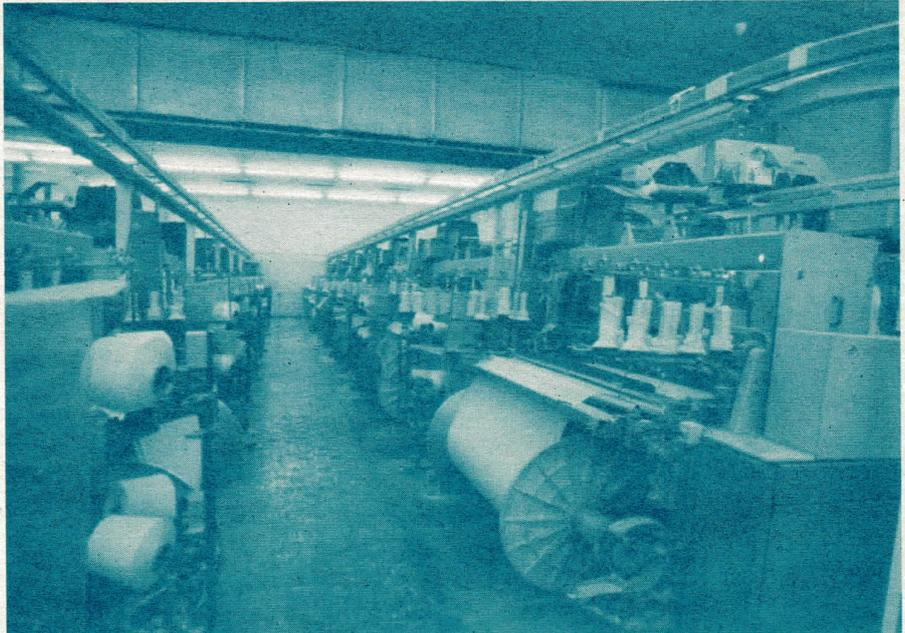
Blick in eine Produktionsstrasse mit modernen Sulzer-Luftdüsenwebmaschinen, die den Schussfaden mittels Luftdüsen eintragen und rund dreimal so schnell arbeiten wie altherkömmliche Schützenwebmaschinen.
