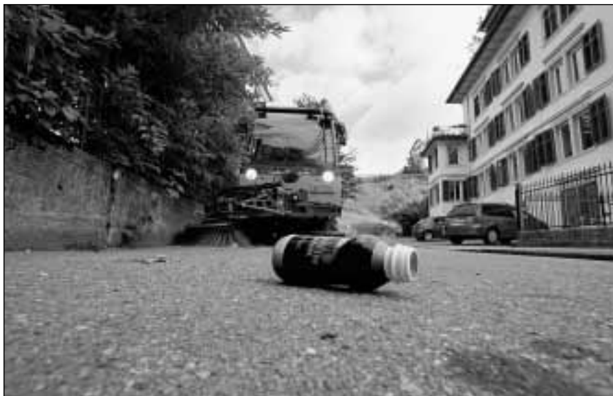
Strassenkehren im Schnecken tempo: Das, was früher von Hand geschah, erledigt heute die Putzmaschine. Wie ein Riesenstaubsauger schlürft sie Dreck und Unrat auf. (Foto: Raphaella Wenger)
