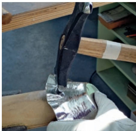
Aufziehen einer Kupa. Der Hammer ist von Ueli Herter geschmiedet.
