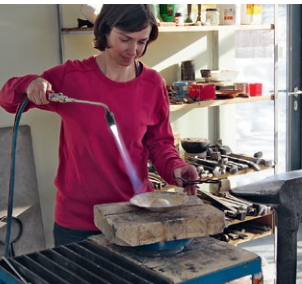
Jenny Scheidegger beim Zwischenglühen des Werkstücks, um das Metallgefüge für die Weiterbearbeitung wieder weich zu machen.
