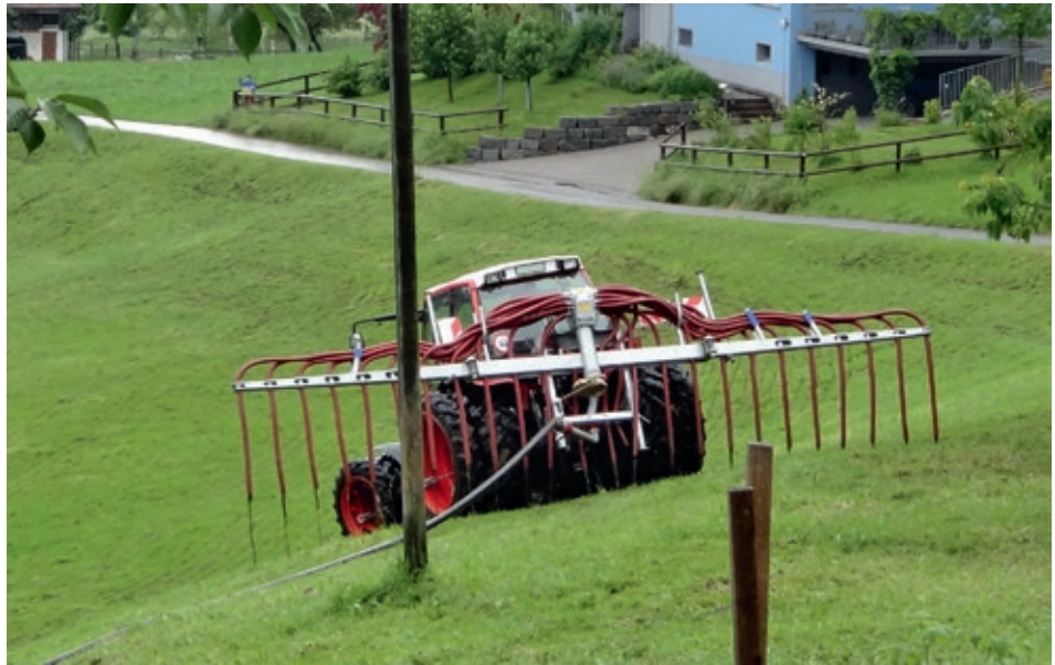
Die Schläuche beim Schleppsystem verteilen die Gülle nahe am Boden. (Foto: ü)
