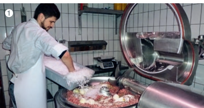
1. Die Fleischmasse wird von Jan Dähler im «Blitz» zusammen mit Zwiebeln und Gewürzen und unter Zugabe von Eisflocken (damit die Masse bei 6000 Messerumdrehungen pro Minute nicht zu heiss wird) ... 2. zu Brät verarbeitet. 3. Mit dem Wurstfüller portioniert Richi Gübeli die Würste je nach Gewicht.
