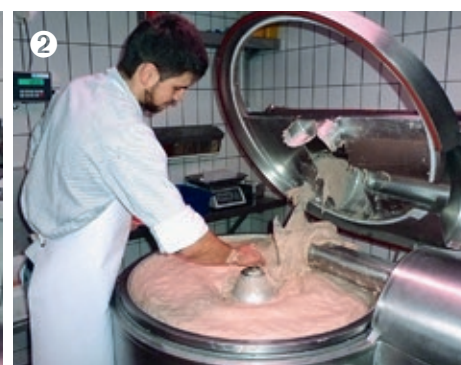
1. Die Fleischmasse wird von Jan Dähler im «Blitz» zusammen mit Zwiebeln und Gewürzen und unter Zugabe von Eisflocken (damit die Masse bei 6000 Messerumdrehungen pro Minute nicht zu heiss wird) ... 2. zu Brät verarbeitet. 3. Mit dem Wurstfüller portioniert Richi Gübeli die Würste je nach Gewicht.
