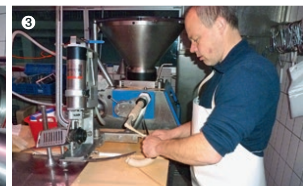
1. Die Fleischmasse wird von Jan Dähler im «Blitz» zusammen mit Zwiebeln und Gewürzen und unter Zugabe von Eisflocken (damit die Masse bei 6000 Messerumdrehungen pro Minute nicht zu heiss wird) ... 2. zu Brät verarbeitet. 3. Mit dem Wurstfüller portioniert Richi Gübeli die Würste je nach Gewicht.
