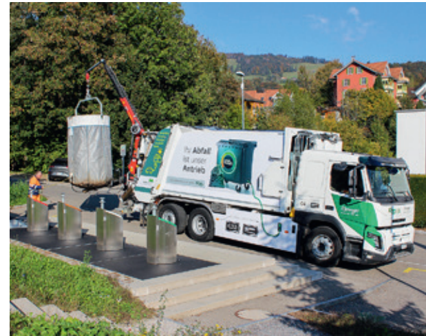
Der voll ausgerüstete Elektro-Kehrichtwagen leert in Wald nur die Unterflur-Container, hier an der Mürtchenstrasse in Laupen. (Foto: Werner Brunner)
